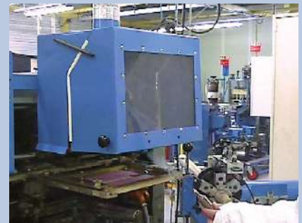
Dispositif de captage fermé en phase d'impression.
