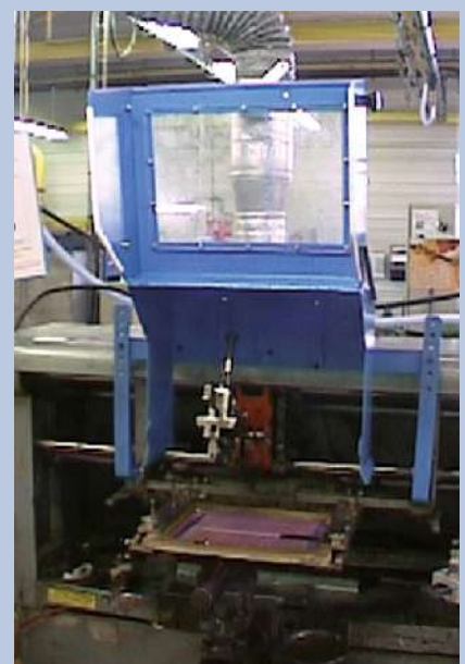
Le dispositif se soulève afin de faciliter le nettoyage de l'écran d'impression.
